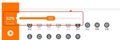
7. 单击左侧菜单栏的【运行】按钮，选择【从起始点运行程序】，进入【移动】界面，长按【自动】至按钮置灰，即移动机械臂到程序初始位姿，此时【点击确定开始程序】按钮使能，单击即可运行程序，机器人在【路点\_0】和【路点\_1】之间移动。
