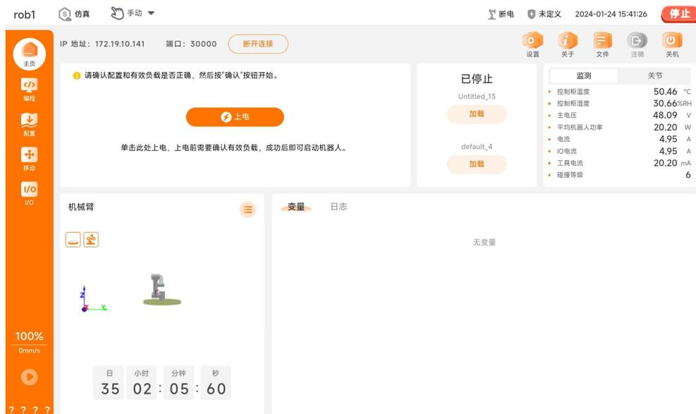
4. 切换连接：单击主页【机器人连接】功能区的【断开连接】按钮，弹出【控制柜连接】窗口，选择控制柜，进入【机械臂连接】窗口，单击目标机械臂对应的【连接】按钮建立连接。
