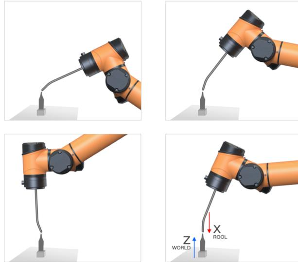
工具坐标系方向则使用目标坐标系以及平面上一点法来标定。
