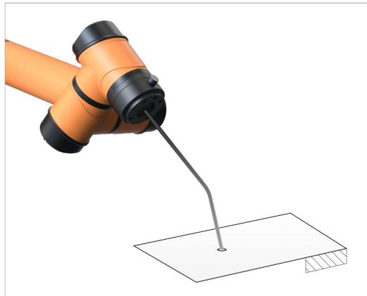
【工具中心点】界面可以设置工具坐标系，因此每个 TCP 都包含相对于工具法兰中心而设定的平移和旋转参数：X、Y 和 Z 坐标指定 TCP 位置；RX、RY、RZ 坐标框定 TCP 方向。当所有值（包括方向）均为零时，TCP 与工具法兰的中心点重合。
