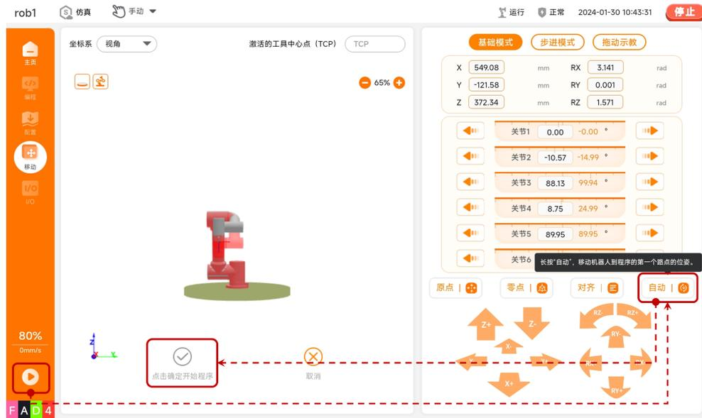
恭喜完成第一个机器人程序！该程序可以实现机器人在【路点\_0】和【路点\_1】两个路点之间移动。
