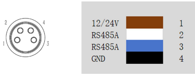
图 3-5 工具 RS485 接口示意图
