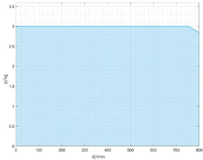
图 2-3 AUBO-i3H 机械臂负载偏移曲线
