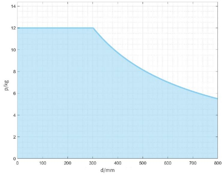
图 2-7 AUBO-i12H 机械臂负载偏移曲线
