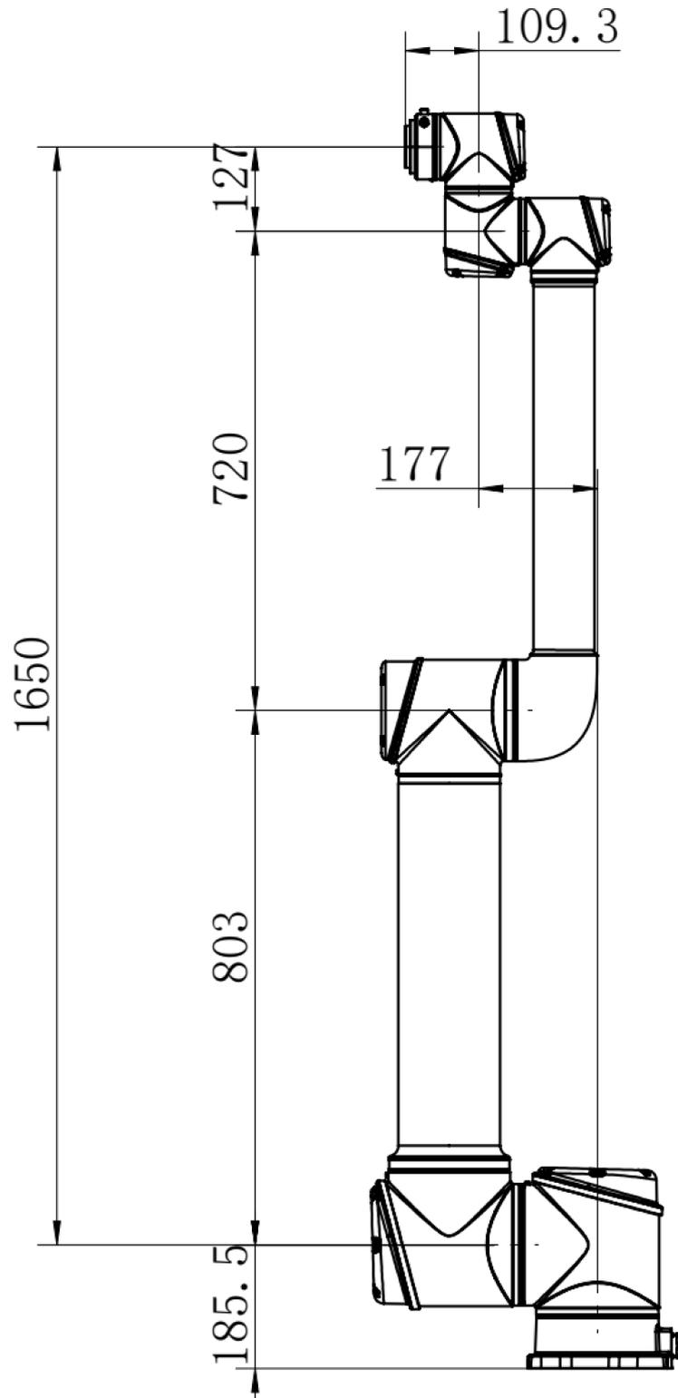
图 2-16 AUBO-i20H 机械臂机械尺寸图
