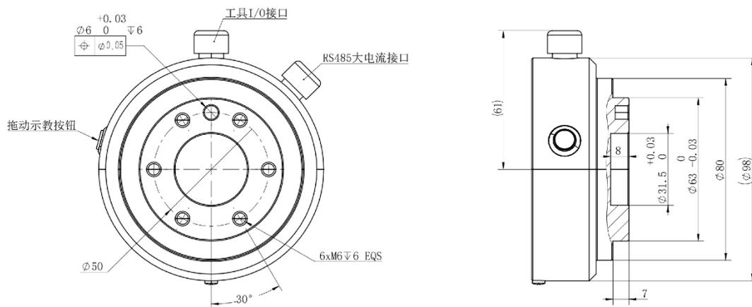
图 2-27 AUBO-i20H 机械臂 C 型末端法兰机械尺寸图
