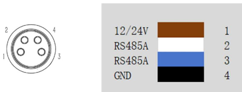
图 3-5 工具 RS485 接口示意图
