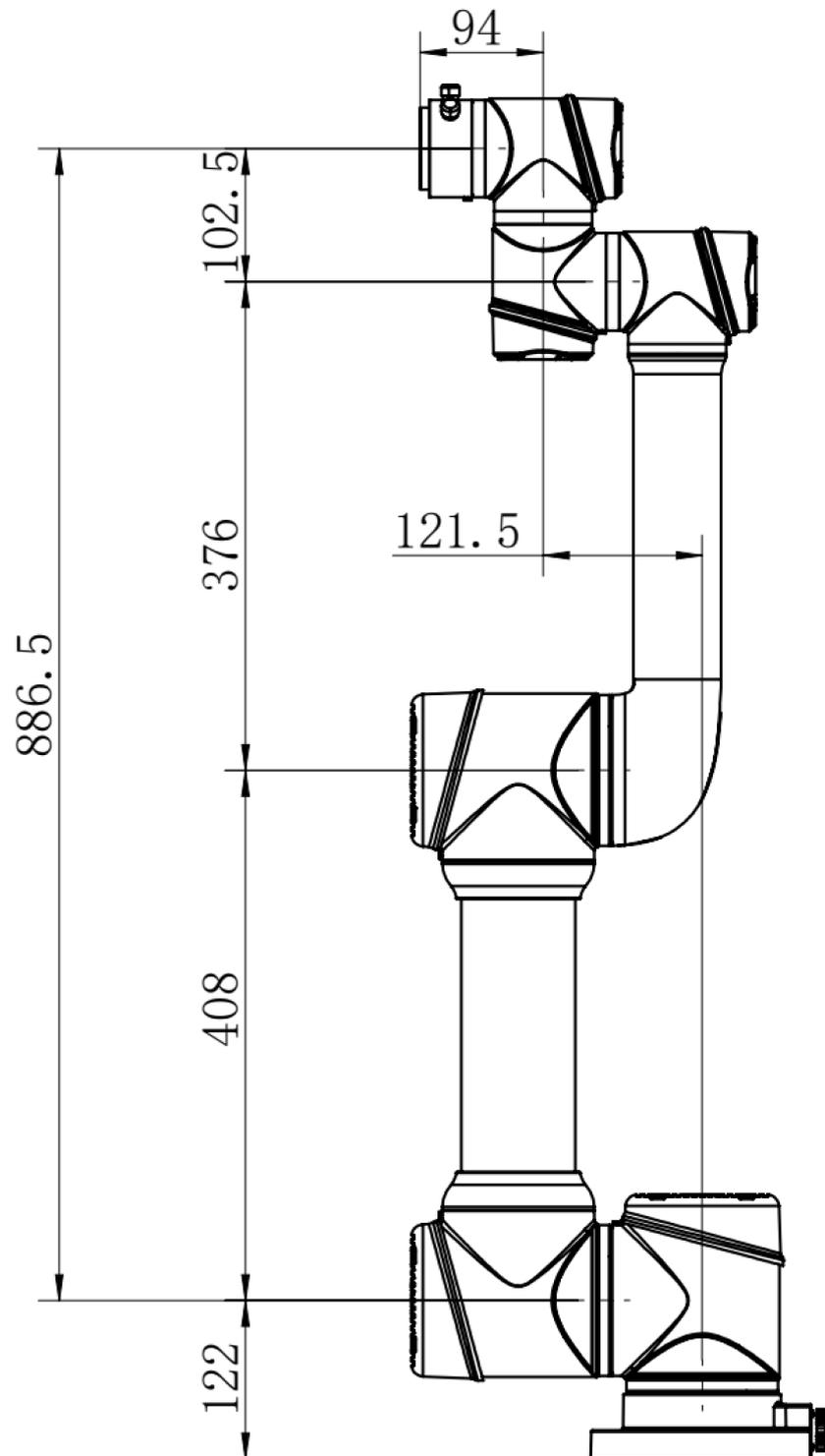
图 2-11 AUBO-i5H 机械臂机械尺寸图
