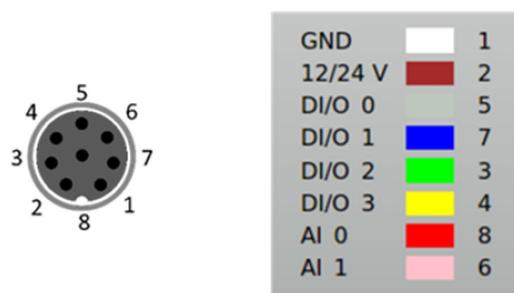
图 3-4 工具 I/O 接口示意图
