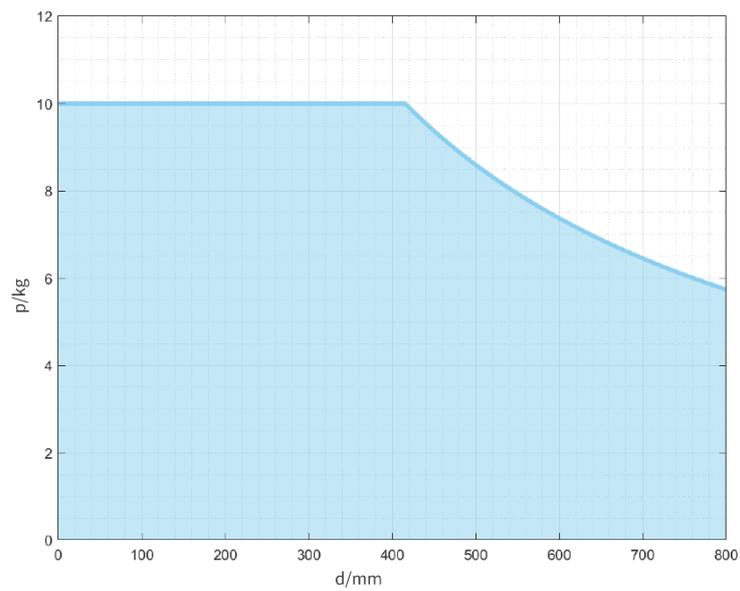
图 2-6 AUBO-i10H 机械臂负载偏移曲线
