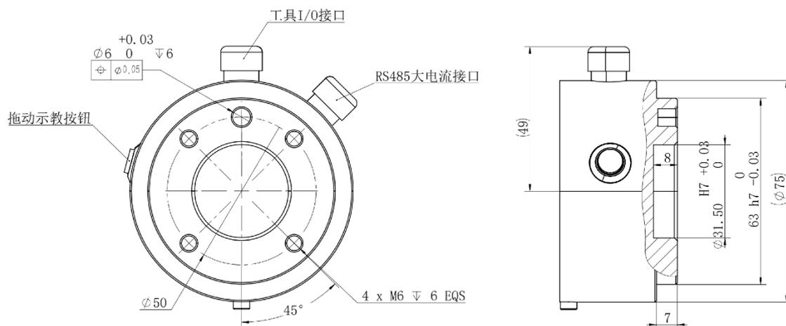
图 2-25 AUBO-i3H、i5H、i7H、i10H 机械臂 C 型末端法兰机械尺寸图
