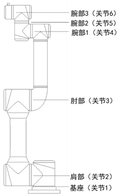
图 2-2 机器人关节示意图
