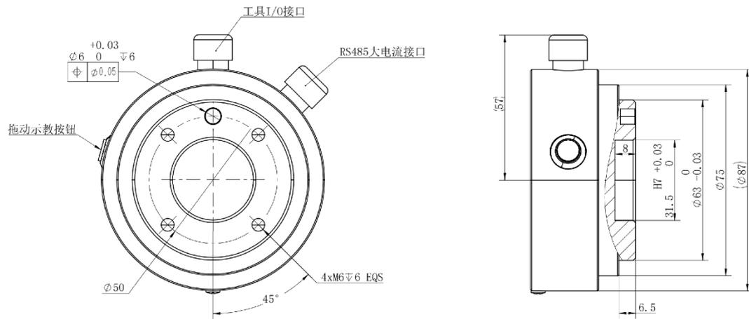
图 2-26 AUBO-i12H、i16H 机械臂 C 型末端法兰机械尺寸图
