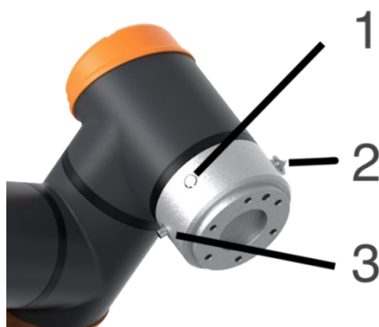
图 3-3 臂侧接口与按钮示意图
