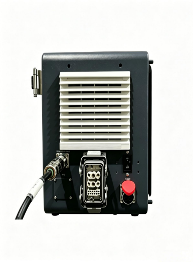
图 5-5 手柄或示教器连接至控制器
