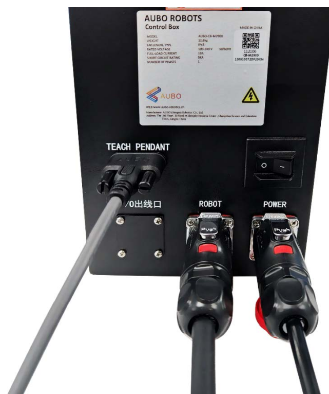
图 5-4 控制器电缆连接示意图
