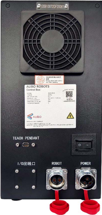
图 5-3 控制柜后面板示意图
