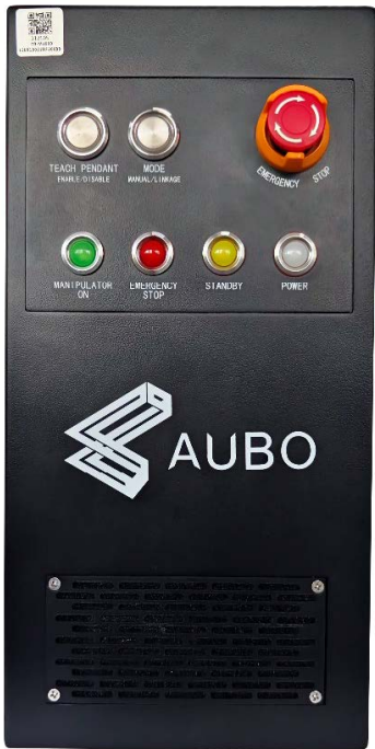
图 5-2 控制柜前面板示意图
