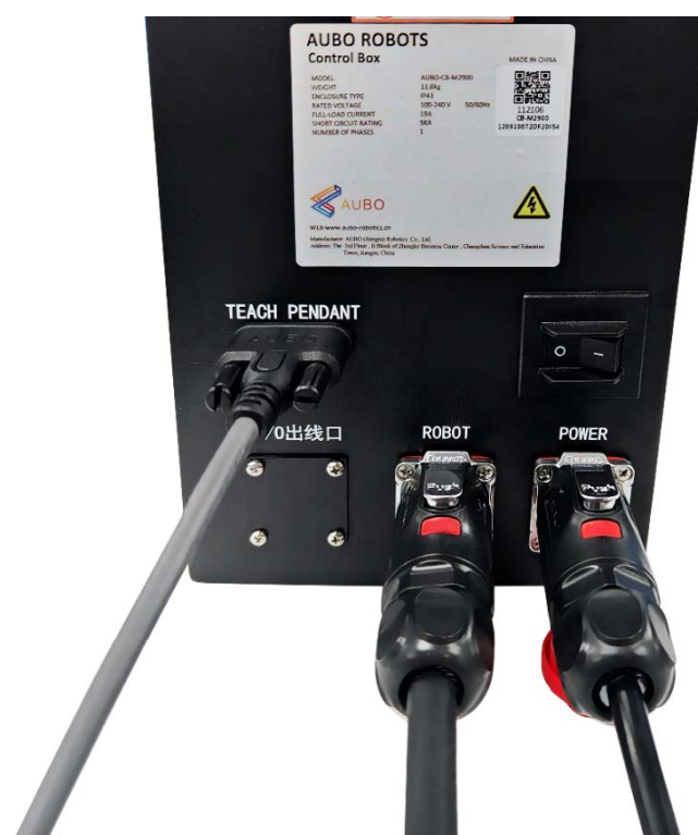
图 5-4 控制柜电缆连接示意图
