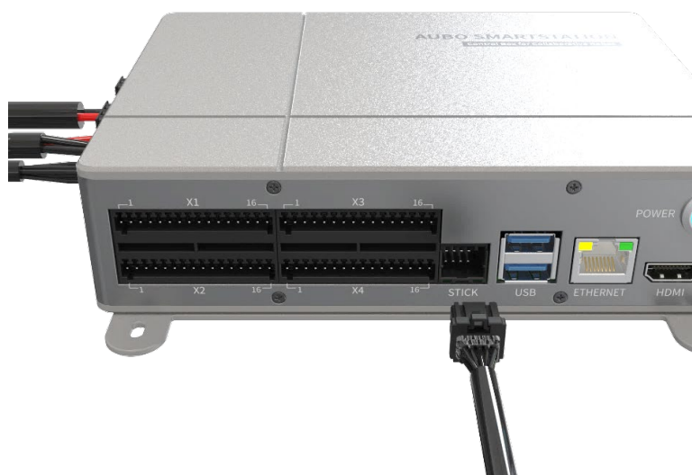
图 5-6 控制手柄连接至控制盒
