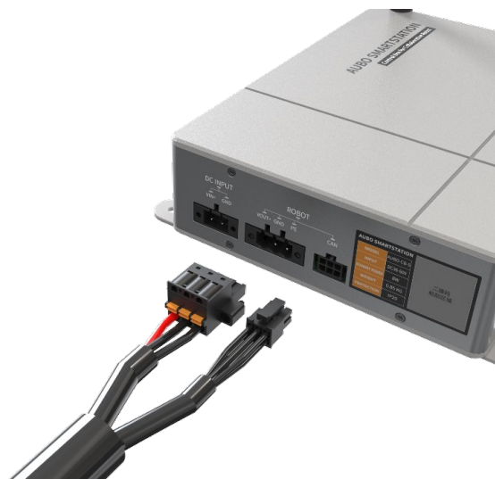
图 5-5 机器人本体电缆连接至控制盒
