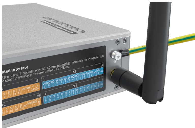
图 5-7 连接接地螺钉
