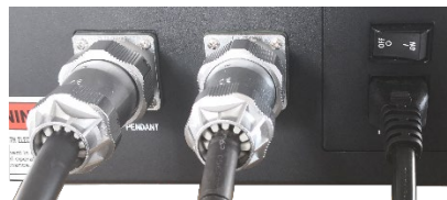
图 5-7 控制柜电缆连接示意图
