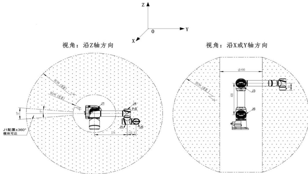
图 6-2 机器人工作空间示意图
