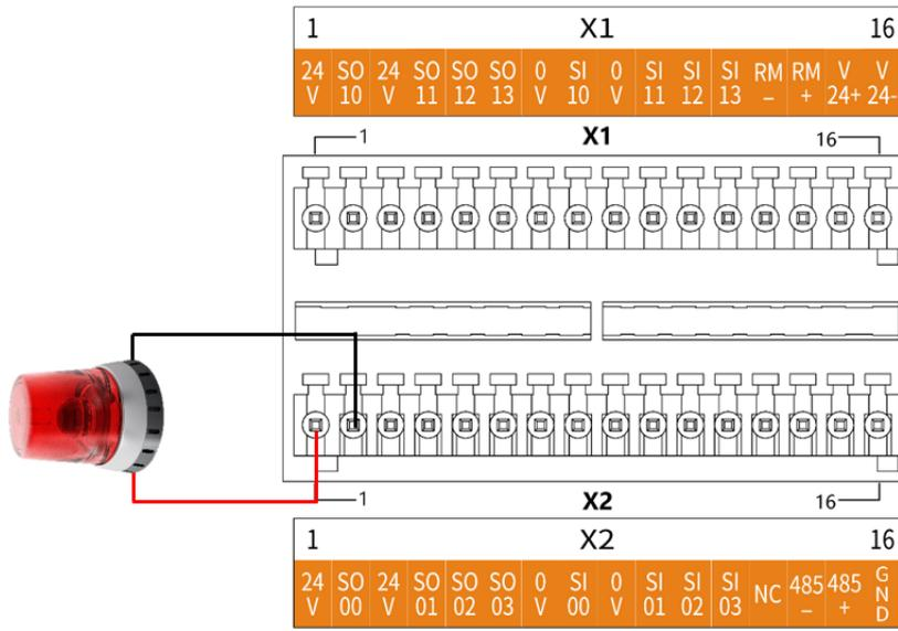
图 8-3 系统紧急停止输出连接示意图
