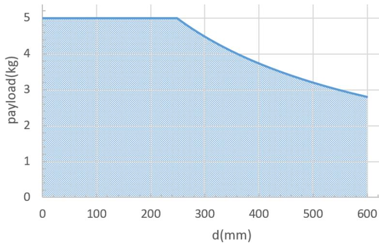
上图所示为机器人腕部有效负载图，其中纵坐标为负载质量，横坐标  $d$  表示重心偏移量，重心偏移量为工具末端法兰盘中心到工具重心之间的距离。
