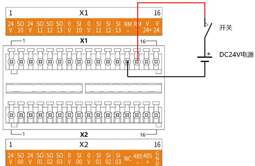
图 8-6 远程开关机控制接线示意图
