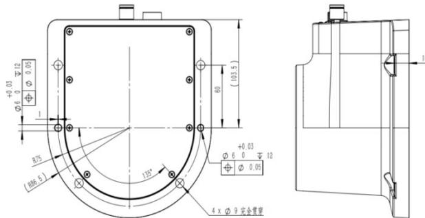
图 10-2 机器人底座机械尺寸图
