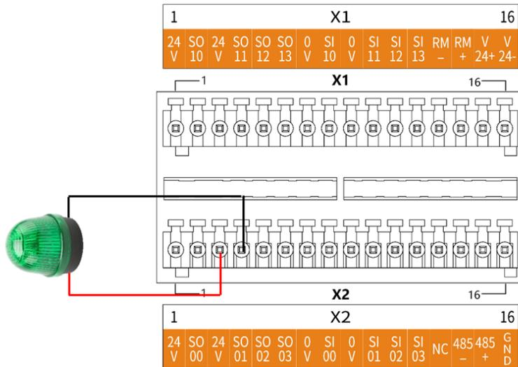
图 8-4 机器人运动输出连接示意图
