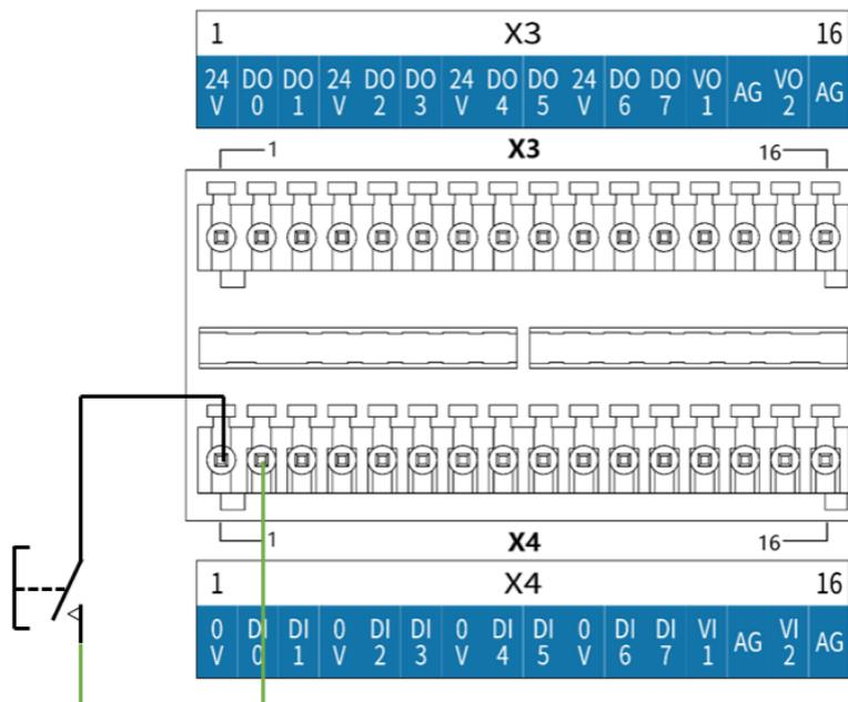
图 8-9 DI 端连接按钮开关示意图
