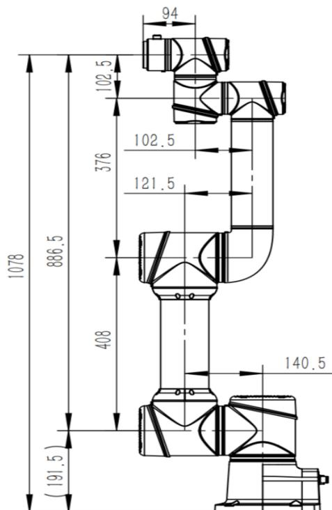
图 6-1 AUBO-ES5 机器人机械尺寸图
