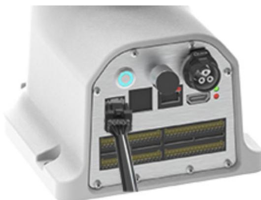
图 10-6 连接控制手柄电缆
