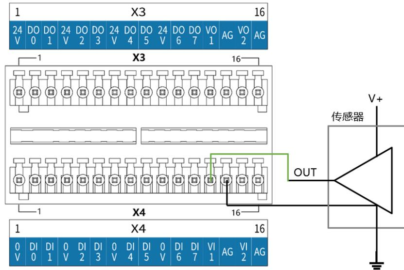
图 8-13 模拟电压输入连接传感器
