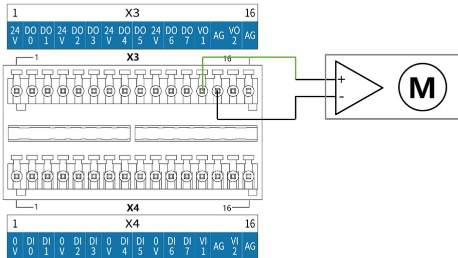
图 8-14 电压模拟输出连接驱动设备
