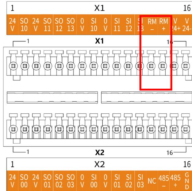
图 8-5 远程开关机接口示意图
