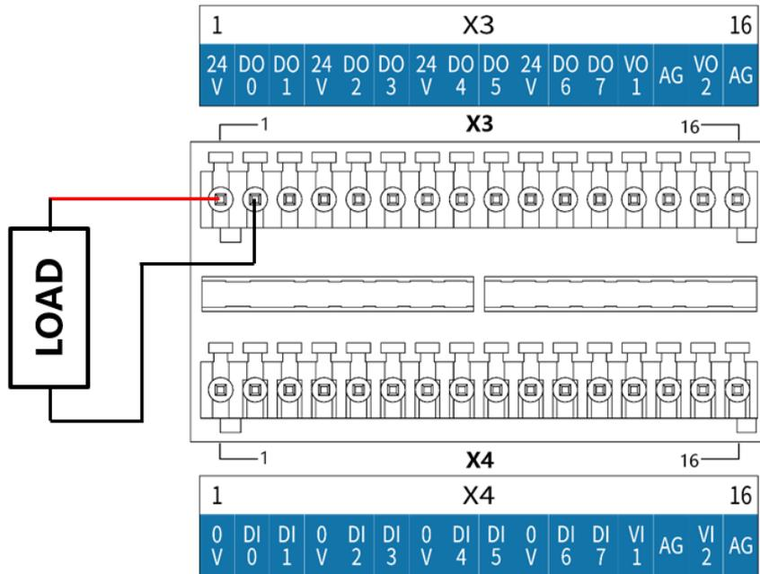
图 8-11 DO 端接负载示意图
