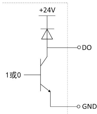
图 8-8 DO 端 NPN 工作方式示意图
