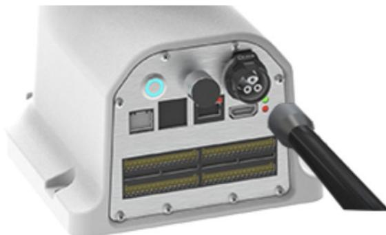
图 10-4 电缆连接至机器人一体化底座
