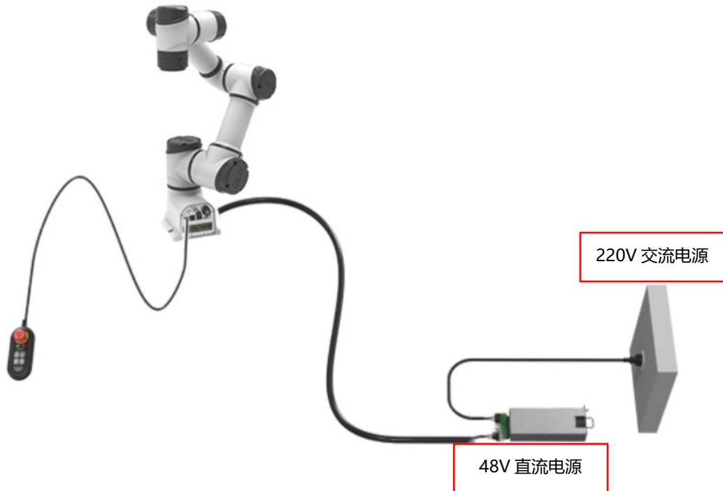
图 10-8 机器人系统连接示意图
