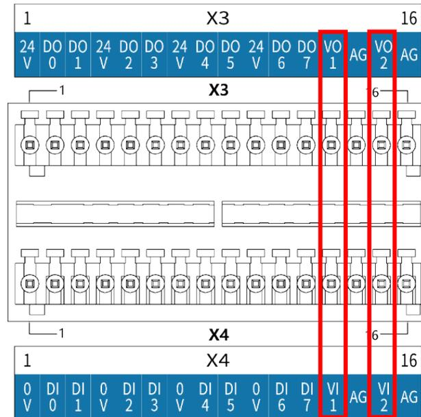
图 8-12 模拟 I/O 接口示意图
