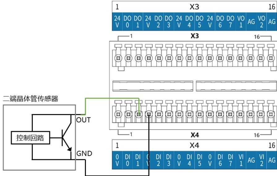
图 8-10 DI 端连接二端传感器示意图
