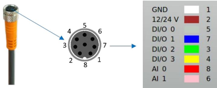
图 8-15 机器人本体工具 I/O 接口示意图
