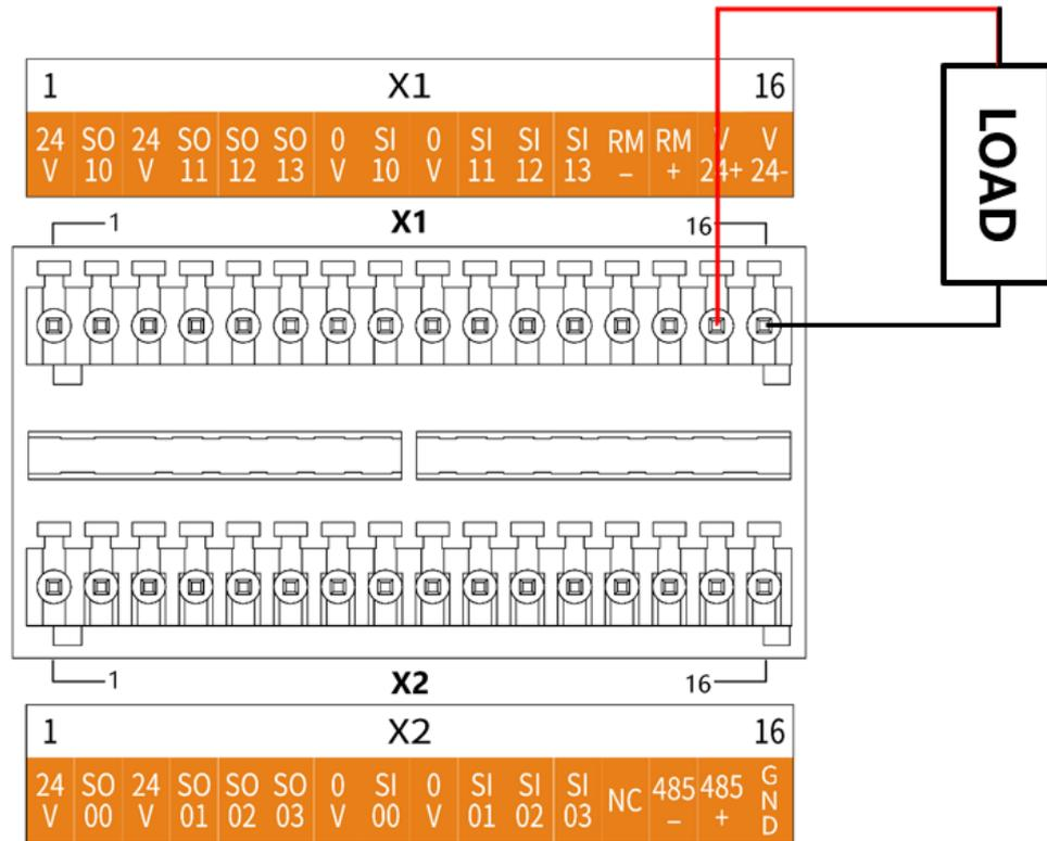
图 8-1 内部电源供电示意图
