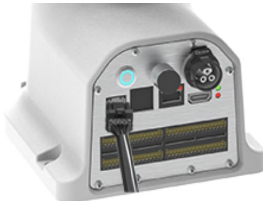
图 10-6 连接控制手柄电缆
