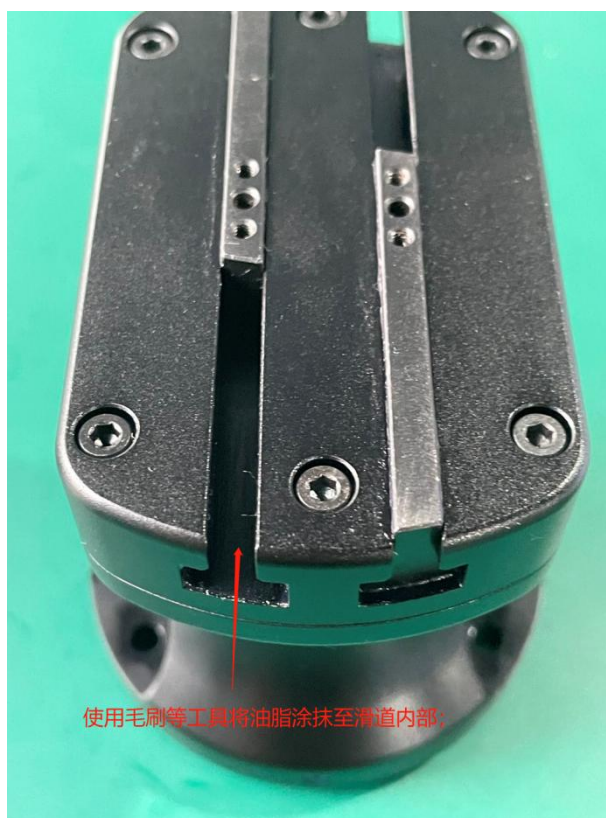
图 10-1 夹爪涂抹油脂示意图
